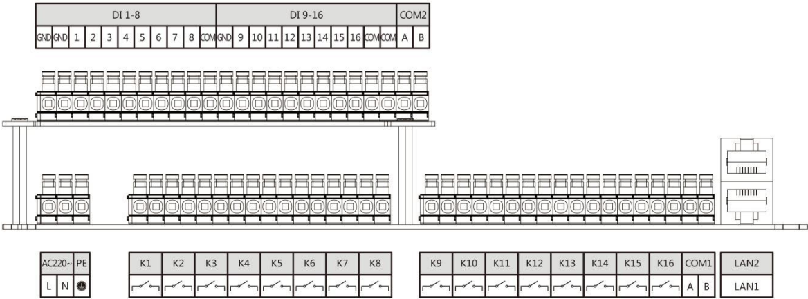
多功能控制单元接线指示图 Multifunctional control unit wiring instruction diagram
